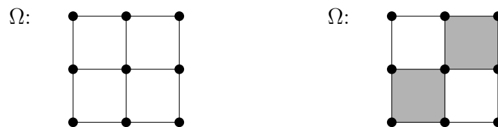
Abbildung 2: Koeffizientenverteilungen auf \Omega . a) Konstant mit \rho = 1 (links) und b) Schachbrettmuster mit \rho = 1 in weiß und \rho = 2 in grau (rechts).
